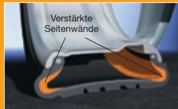
SSR-Reifen bei Luftverlust: Aktionsradius bis zu 80 km bei max. 80 km/h Höchstgeschwindigkeit.
