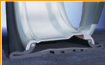
Konventioneller Reifen bei komplettem Luftverlust: Reifen wird nach kurzer Strecke zerstört.
